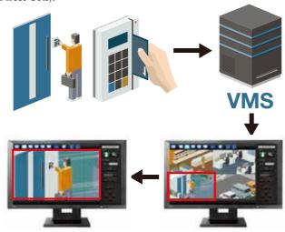
Beispiel: Automatischer Layout-/Bildwechsel beim Einsatz einer Schlüsselkarte.
